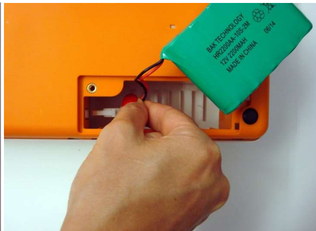
2. Desconecte el conector de la batería.
