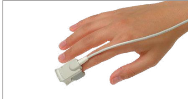
Ilustración 5-11: Colocación del sensor de SpO2 estándar (ejemplo)
