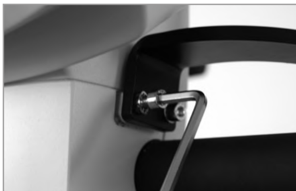
Ilustración 4-7: Fijación del portaelectrodos con tornillos
