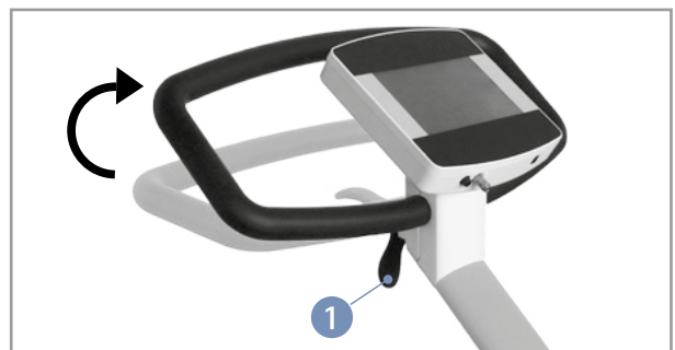
Ilustración 6-2: Ajuste del manillar
